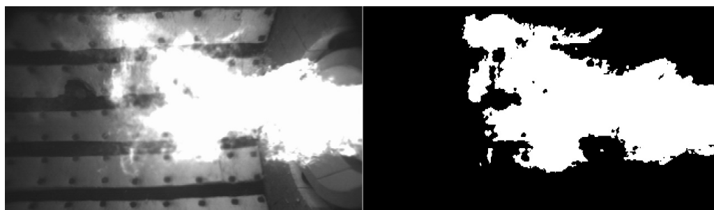
Figura 1: Exemplo de limiarização de uma imagem de chama a óleo pelo Método de Otsu. Fonte: Silva Neto et al. (2019).
