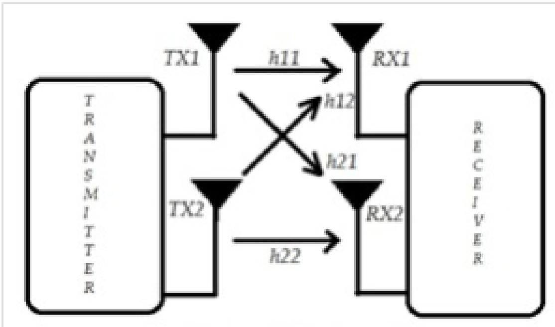
**Figure 2:** MIMO SYSTEM MODEL .
